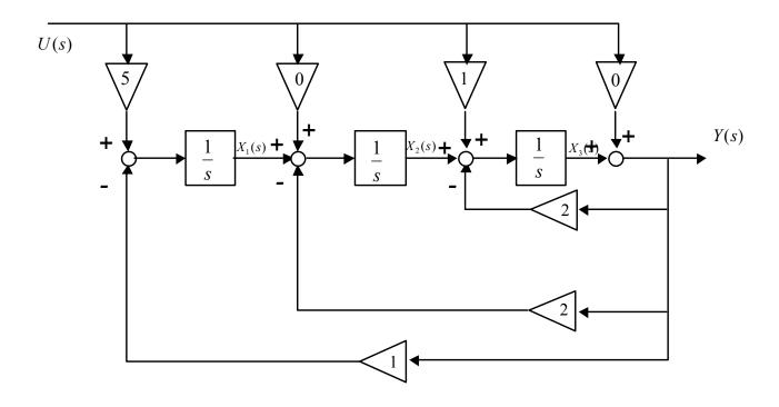
$$\begin{bmatrix} \dot{x}_1 \\ \dot{x}_2 \\ \dot{x}_3 \end{bmatrix} = \begin{bmatrix} 0 & 0 & -1 \\ 1 & 0 & -2 \\ 0 & 1 & -2 \end{bmatrix} \begin{bmatrix} x_1 \\ x_2 \\ x_3 \end{bmatrix} + \begin{bmatrix} 5 \\ 0 \\ 1 \end{bmatrix} u(t),$$
