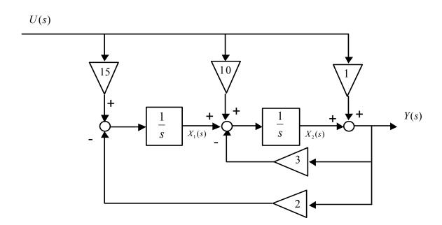
$$\begin{bmatrix} \dot{x}_1 \\ \dot{x}_2 \end{bmatrix} = \begin{bmatrix} 0 & -2 \\ 1 & -3 \end{bmatrix} \begin{bmatrix} x_1 \\ x_2 \end{bmatrix} + \begin{bmatrix} 13 \\ 7 \end{bmatrix} u(t),$$
